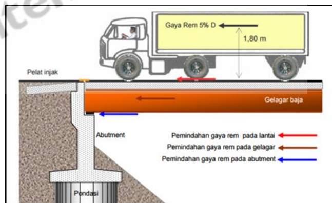
Gambar 2.9 Gaya Rem dari Beban Lajur
