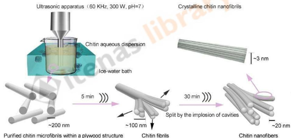
**Gambar 2.10 Pembuatan Nanokitosan Menggunakan Ultrasonikasi**
