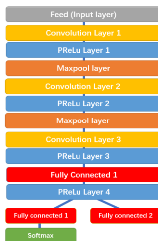
Gambar 2. 9 Representasi cara kerja MTCNN pada jaringan R-Net
