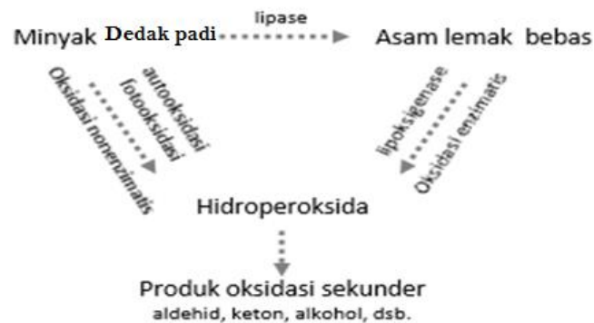
Gambar 2.4 Mekanisme Kerusakan Hidrolitik dan Oksidatif pada Minyak Dedak Padi
