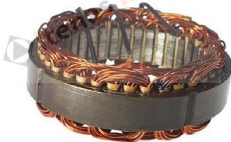
Gambar 2.10 Inti stator dan alur pada stator (Sumber: GoeritnoArif,2016)
