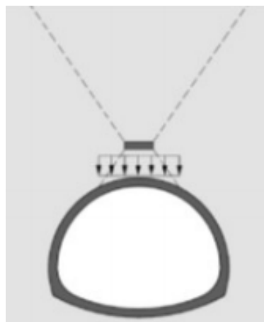
Gambar 2.10 Pembebanan lapisan terowongan pada compensation grouting
