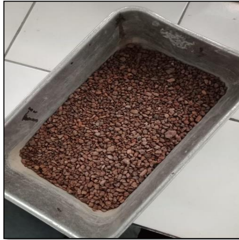
Gambar 2.2 Agregat Halus Lumpur Sidoarjo
