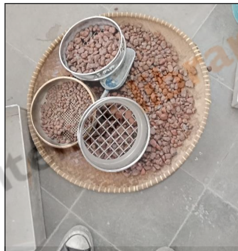
Gambar 2.3 Agregat Kasar Lumpur Sidoarjo
