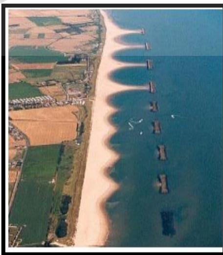
Gambar 2. 2 Pemecah Gelombang Lepas Pantai
